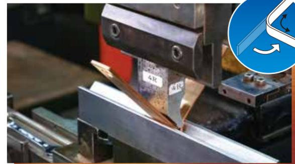
曲げ加工は、銅板を厚さ方向に曲げる加工方法です。エッジワイズ加工に比べると、一般的な曲げ加工法といえます。曲げる時に銅板が伸びるため、伸びを逆算して正しい寸法となるように曲げていくことがポイントです。
