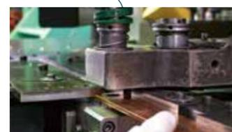
取り付け穴となる穴を開ける工程です。製品によって穴の数・位置が異なるため、図面に合わせて正確に穴を開けていきます。
