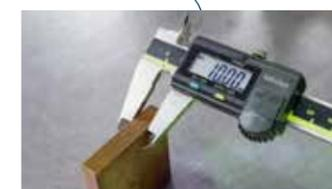
複数の計測器具で寸法のチェック、正しい加工ができているか、傷などの外観検査など、完成した製品の全体をチェックし、品質を確認します。
