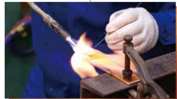
部品と部品の間に溶解した「ロウ材」を流し込み、部品と部品を固定する加工です。銅を溶かすことなく均等にロウを回すために800度~1000度以内の温度をキープし、接合する必要があります。国家資格もあり経験と高い技術を要する加工です。
