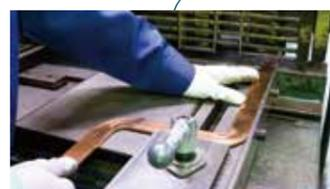
エッジワイズ加工後に行う曲げ加工において、板厚によって生じる伸び率を計算し、予め寸法を微調整しておきます。
