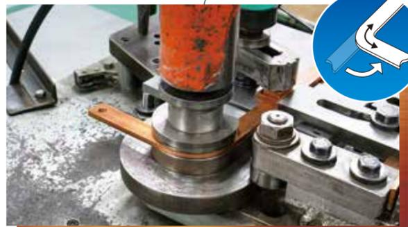
エッジワイズ加工とは、銅板の長辺を横方向に曲げる加工のことをいいます。市販の加工機械がないため、独自で機械を開発して加工を行っています。内と外の板の厚さ(偏肉)を最小限に抑えることが重要となり、高い技術力を必要とする加工です。
